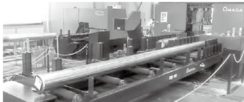
長尺（6m）、大径（Φ430）の切断が可能
