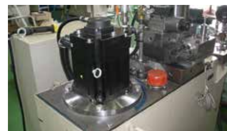
(図3) 次世代ハイブリット型パワーかしめ装置
