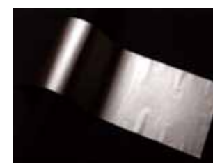
一般的な金属箔 平坦度：1000mm/1mm 材料両端部が浮いているため、レーザーなど光学加工する場合、焦点距離がずれるため陰像の境界がぼやけて精密に加工できない
