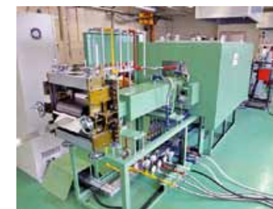
連続焼鈍炉 本計画ではこの焼鈍炉を改良することで、低コストで新技術の開発に成功した
