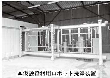
▲仮設資材用ロボット洗浄装置
