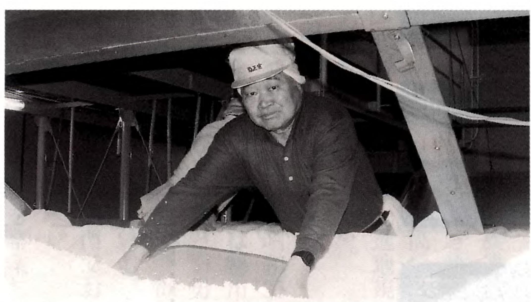
麹造り後半の20時間を過ごしたヴィサー式自動製麹機から、搬出用の台車へと麹を取り出しているところです。約20cmの厚さに積まれた麹は特有の香りと温もりを持っています。
