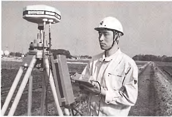
写真上・GPSを使った測量現場。宇宙開発技術の発展により人工衛星を利用した測量が実用化、ほとんど誤差のない測量が可能となっている。同下・高度な処理システムを搭載したコンピューターが並ぶ(株)つくものシステム事業部門。「測量というのは紙と鉛筆さえあればよくて金がかからないと思われがちですが、電子納品の時代、膨大な設備投資が必要」と中嶋理事長は言う。
